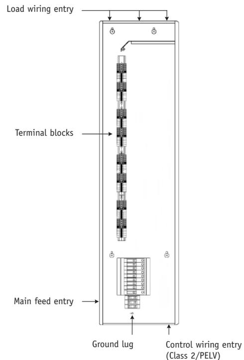
**Figure 22 – wiring entry**
