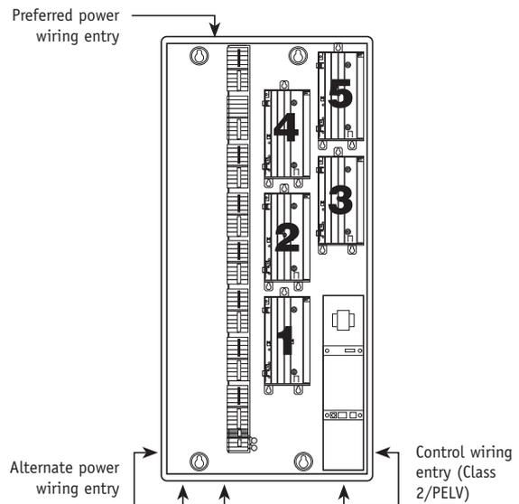
**Figure 2 – wiring entry**
