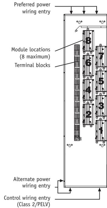
**Figure 2 – wiring entry**
